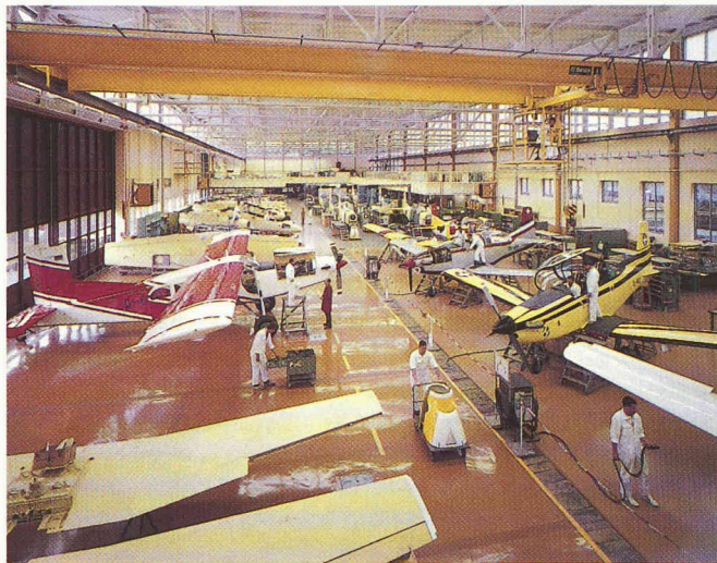
Dans la grande halle de Pilatus: les «Hawk» en cours de montage pour la Suisse y côtoient aujourd'hui les PC-6, PC-7 et PC-9.
