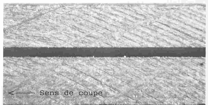
Fig. 8. — Surface usinée à la fraise à contourner pour composites.
