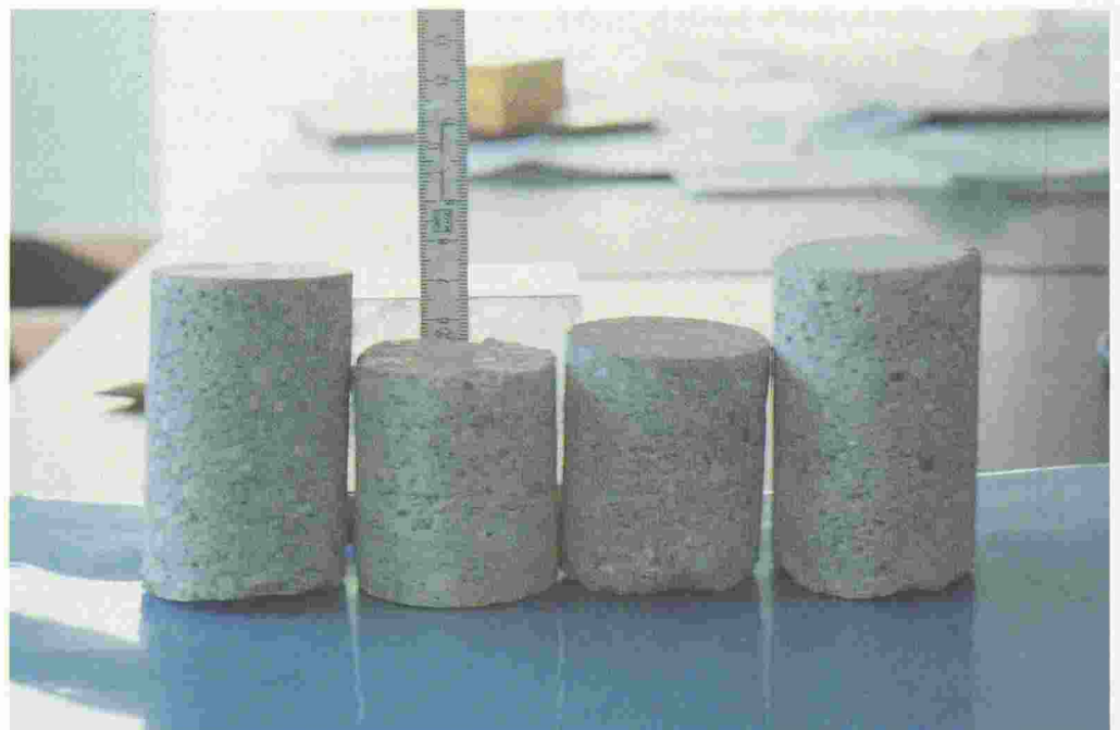
Fig. 6. – Prélèvement de carottes dans le même local. Variation d'épaisseur : 50 à 80 mm.
