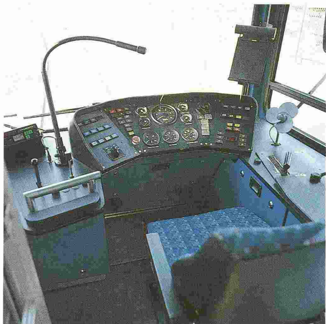
Fig. 5. - Poste de conduite de l'automotrice.
