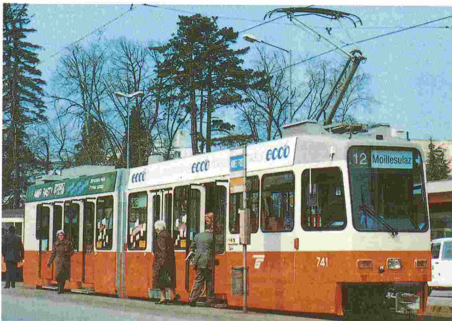
Fig. 5. - Tramway articulé à plancher surbaissé des Ateliers de Constructions Mécaniques de Vevey pour les Transports publics genevois.
