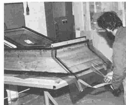
Les fenêtres de toiture complétées d'un cadre intérieur sont équipées en usine de barrière de vapeur (notre illustration), couche d'isolation thermique et sous-couverture sans joint.
