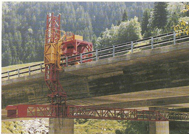
Fig. 3. – Equipement de contrôle «Moog» MBS 200 en action sous le tablier. (Photo A. von Glutz.)
