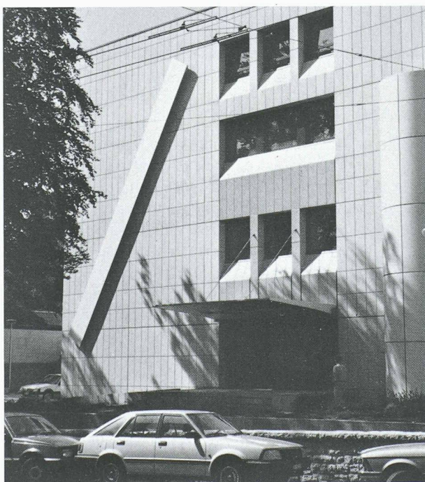
Centre de télécommunications de Neuchâtel. Le panneau de décoration construit par Décision SA mesure 13 m de long et 1 m de large. Il se compose de plaques d'aluminium collées sur du nid d'abeille alu de 10 cm; son poids est inférieur à 200 kg. Il est monté sur des silentblochs, afin d'éviter les vibrations.
