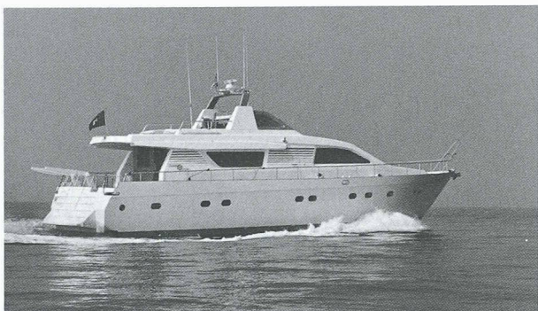
Alalunga Composit 22: 22 m de long, 5,76 m de large, 39 t à pleine charge, 2 x 1100 CV, 38 nœuds (70 km/h) de vitesse maximale.
