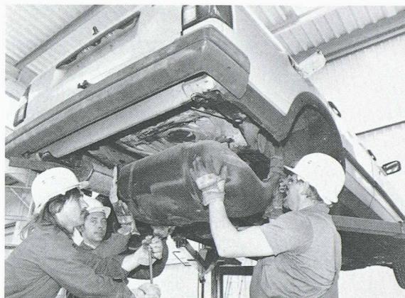
Projet pilote de récupération et de recyclage de vieilles carcasses d'automobiles en Allemagne du nord: dans une entreprise de Leer, en Frise orientale, des ouvriers sont en train de démonter le réservoir en plastique d'un véhicule devenu irréparable.
