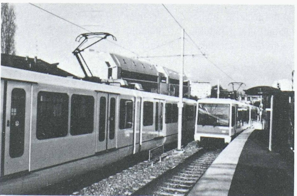
Fig. 13. – Montelly, une des onze stations de croisement du TSOL. Les stations du métro léger sont à quais hauts (photo TL/Maeder).
