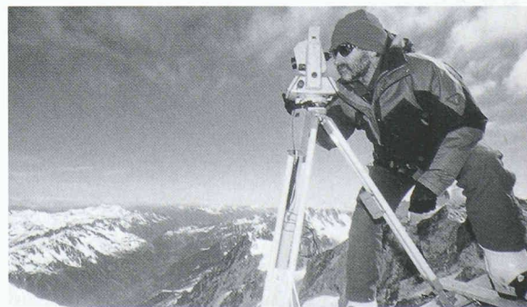
Les lieux de prélèvement de glace ont été déterminés à l'aide de mesures radar et de relevés réalisés avec l'instrument électronique de mesure laser Wild TC1610. Ces données recueillies à une altitude de 4300 m permettent au savant Louis Reynaud (photo) de calculer les variations de volume et les vitesses de déplacement de la glace.
