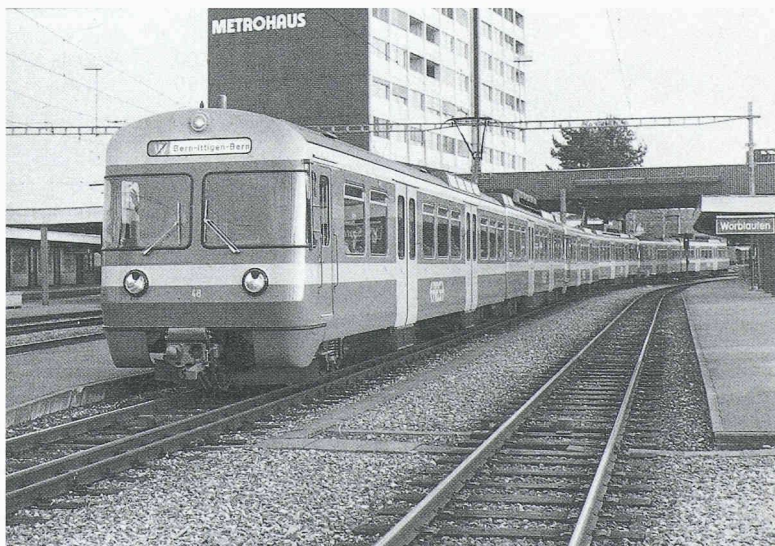
Fig. 3. – Une réalité quotidienne sur le RBS: trois Be 4/8 à Worblaufen sur la ligne W. Une telle rame offre 384 places assises et autant de places debout à limite de capacité: aux heures de pointe, certaines circulations atteignent déjà une charge de 600 personnes. A quand une telle exploitation en Suisse romande?
