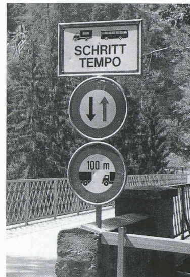
Fig. 3. – Exemple de signalisation pouvant influencer les caractéristiques du trafic utilisant un ouvrage
