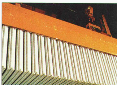
Carreaux de plâtre en cours de fabrication.
