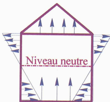
Fig. 3.- Position du niveau neutre
