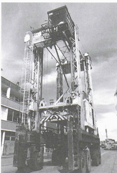
Ces engins sur pneus, capables de lever et d'entasser des conteneurs jusqu'à trois couches, desservent les autres quais que celui du terminal spécialisé.
