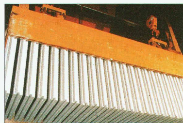
Carreaux de plâtre en cours de fabrication.
