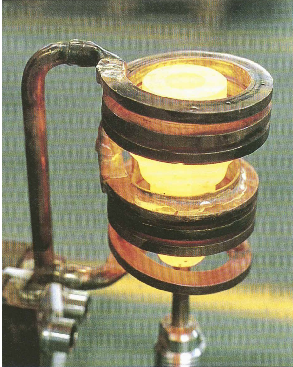
Fig. 2. – Chauffage en surface d'une tête de forage. Les temps de chauffe sont d'environ 20 secondes, avec un courant de plusieurs milliers d'ampères
