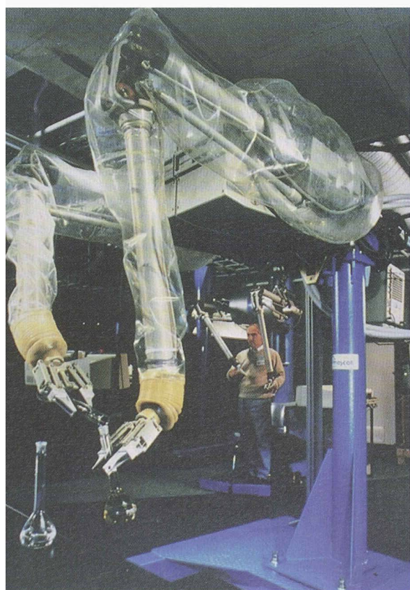
Fig. 1. – Essai du manipulateur maître-esclave à retour de force ascot4 du JET. Ce manipulateur est capable de saisir aussi bien de petits objets, avec une sensibilité extrême (jusqu'à 70 gr.), que des poids de 20 kg (photo JET).
