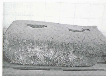
Fig. 2. – Anode endommagée par une combustion au CO_2
