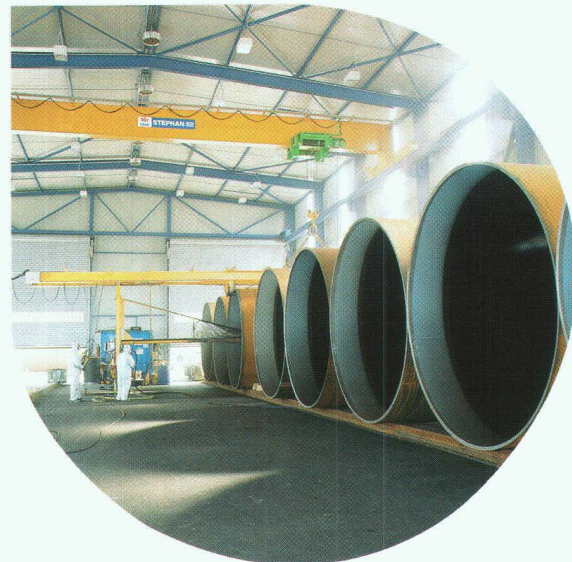
Cleuson-Dixence, revêtement industriel des tuyaux
