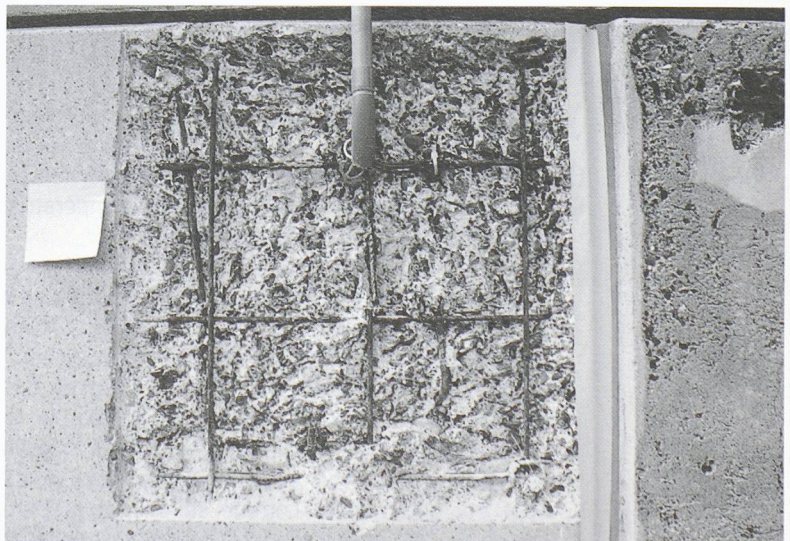
Fig. 1. Zones de mesure «re-profilées», avant le re-profilage
