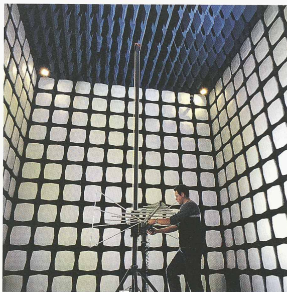
Fig. 10: L'utilisation de sondes meilleur marché et plus simples est préconisée dans certains cas; l'étalonnage peut alors se faire dans la cellule GTEM. (Photos METAS)
