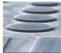
Cavités à microdisques contenant en leur centre une « boîte quantique » (Document Valéry Zwiller, ETHZ; montage Atelier Poisson)
