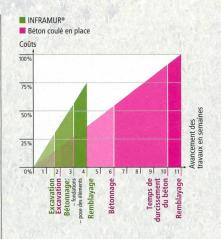
Temps de construction considérablement réduit; 20 à 25 % d'économie par rapport aux murs en béton coulés en place.
