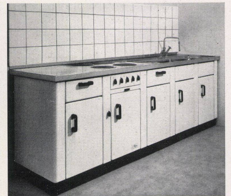
Spültischkombination der Firma «Le Réve», Genf, mit elektrischem Kochherd «Le Réve», Abdeckung und Spülbecken aus poliertem Chromstahl, Unterbau und Herd aus säurefestem, feueremailiertem Stahlblech.
