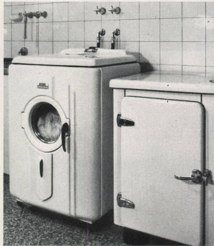
1 Fahrbare elektr. Waschmaschine « Apex ». Gewicht: zirka 80 kg. – Maße: 65 × 65 × 120 cm. Motor: ¼ Ps 220 Volt. – Fassungsvermögen: 4 kg Trockenwäsche. Firma Jacques Bärlocher A.G., Zürich
