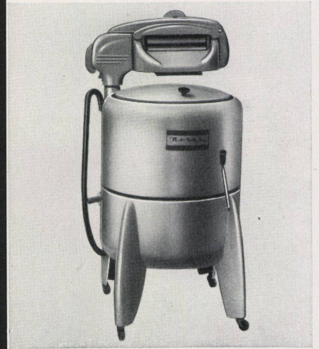
10 Fahrbare elektrische Ro-Ta-Tor-Waschmaschine mit Laugenpumpe. Gewicht: zirka 65 kg. Maße: 59 × 91 cm. Motor: \frac{1}{4} PS 220 Volt. Firma Royal & Co. AG., Zürich
