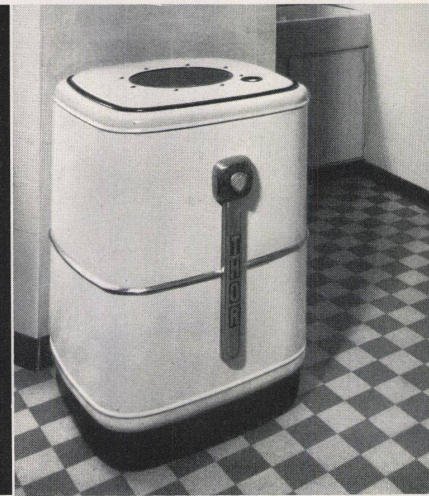
10 Fahrbare elektrische Ro-Ta-Tor-Waschmaschine mit Laugenpumpe. Gewicht: zirka 65 kg. Maße: 59 × 91 cm. Motor: \frac{1}{4} PS 220 Volt. Firma Royal & Co. AG., Zürich
