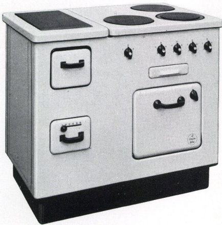
Elektro-combi Herd: Elektrisch – Holz – Kohle mit 3 Kochplatten, Brat- und Backofen / Auffängschale und Schublade / Kohlenabteil mit plangedrehter Einlageplatte für elektrisches Kochgeschirr / Höhe des Herdes 800 mm / Gewicht ca. 150 kg. Firma Cordon Bleu, Lausanne
