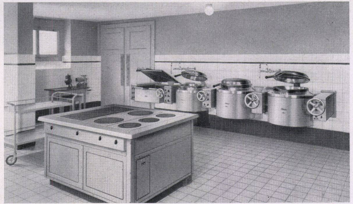
Klinikküche Privatklinik Dr. Barraud Lausanne 1 Hotelherd, schwere Ausführung, drei Felder mit Backöfen 2 Kippkessel, 80 Liter 1 Kippkessel, 50 Liter 1 Bratpfanne, 560 x 560 mm Maxim AG., Aarau
