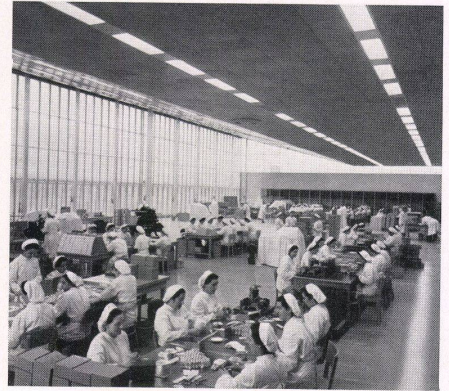
Innenansicht der großen Arbeitshalle, in welcher die pharmazeutischen Produkte abgefüllt und sortiert, etikettiert und in Kartons verpackt werden. An der Decke sind die Aluminiumtafeln der Frengerheizung und die versenkten Beleuchtungsanordnungen sichtbar.
