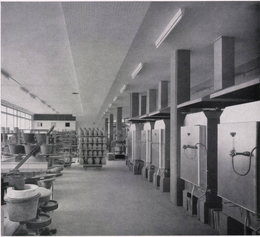
1 Fabrikationsaal im ersten Obergeschoß, Teilansicht mit der Dreherei und den elektrischen Kammeröfen. Salle de fabrication. Production hall.
