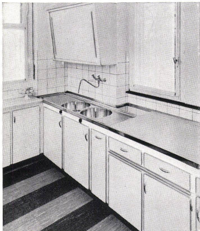
Spültischseite in der umgebauten Küche eines Herrschaftshauses in Basel. Spültischhöhe 90 cm, Herd in Normalhöhe von 80 cm auf der gegenüberliegenden Seite. Schrankunterbauten mit auf Rollen voll ausziehbaren Spezialtablen für Küchenmaschinen. Der «Fresco»-Spar-Spültisch selbstverständlich mit separatem Ausguß.
