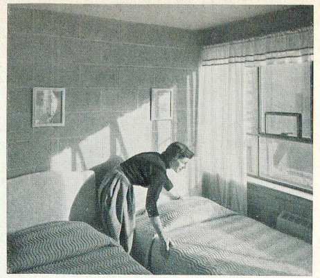
Typischer Schlafraum. Wände aus unverputzten Porenbetonsteinen, Stahlfenster.
