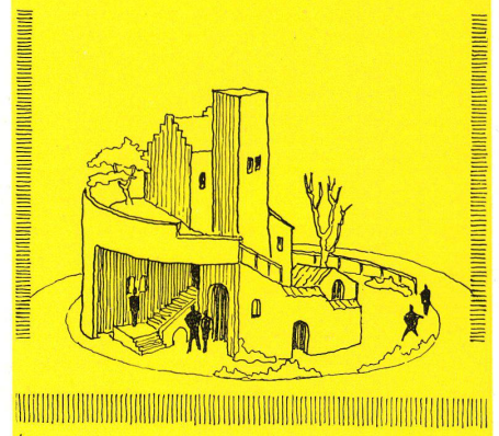
4 und 5 Schematische Darstellung einer Drehbühne nach Reinhardt, wo bei offenem Vorhang, und während sich das Spiel fortsetzt, der Aufbau gedreht wird und so der Szenenwechsel zustande kommt.
