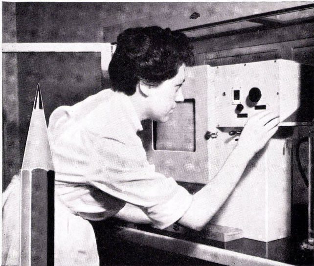
Sedimentationswaage für die Graphit-Korngrößen-Bestimmung
