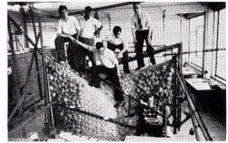
14 Das Sperrholzmodell unter einer schweren Überbelastung!
