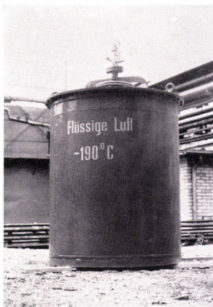
Transportbehälter für flüssige Luft – Isolationsstärke 22 cm
