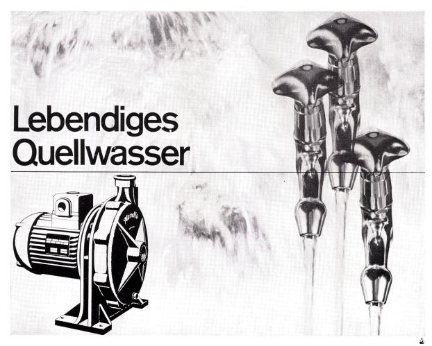
Elektrische Monoblock-Zentrifugalpumpe Typ PLNK für Fördermengen von 10 bis 50 l/min. bei 13 bis 21 m manometrischer Höhe.
