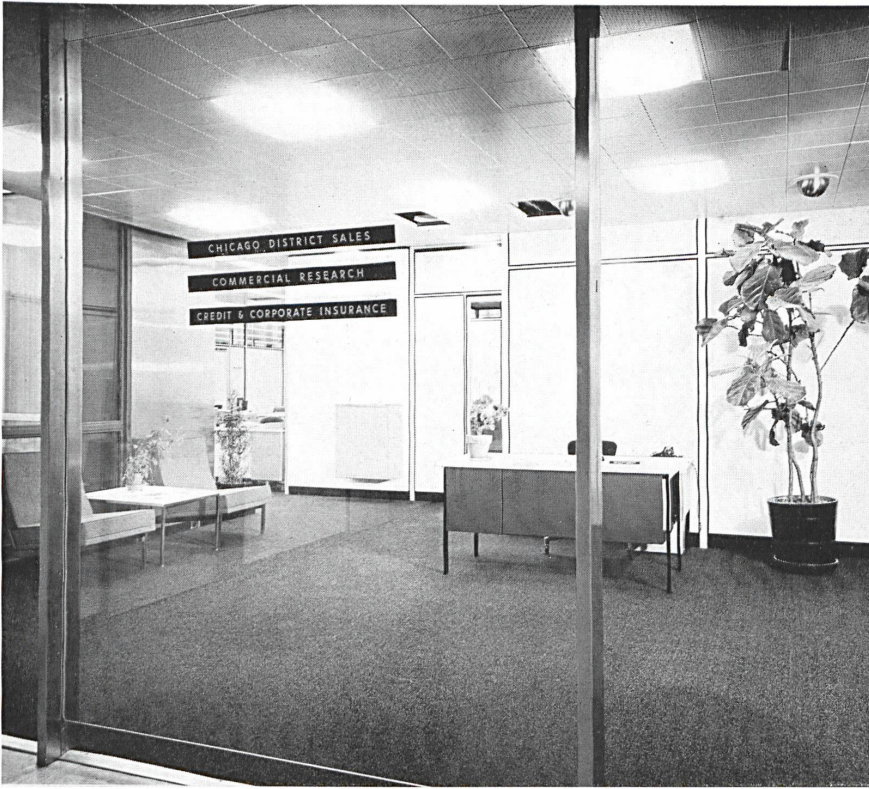
1 Empfangsraum in der 11. Etage. Perforierte Metalldecken. Stahlprofile für die versetzbaren Zwischenwände. Salle de réception au 11e étage; plafond en métal perforé; profils en acier recevant les cloisons mobiles. Reception on the 11th floor. Perforated metal ceilings. Steel profiles for the movable partition walls.
