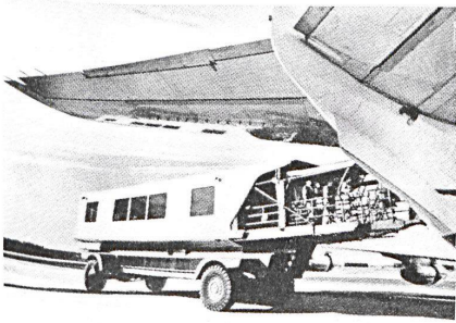
1 Flugplatzmobile (Eero Saarinen) am Jetplan. Die Teleskoprampe ist ausgefahren. Die Fluggäste sind im «ersten Stock» vom Air-Terminal hergefahren worden.
