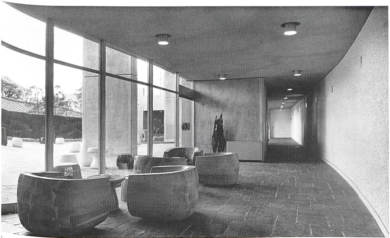
2 Die Tanzbar im Gartengeschoß, links Bartisch mit Tanzfläche, leicht vertieft. Boden: Teppich. Tanzfläche und Barkorpus: Marmor. Wand: Zyklopenwand aus Bruchsteinen. Decke: Schwarzes Zonolit. Bartisch: Zelkova-Holz.
