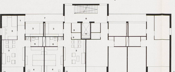
4 Normalgrundriß des Laubenganghochhauses A (Zwei- und Drei-Zimmer-Wohnungen) 1:200. Plan type de la maison-tour A à coursives (appartements de 2 et 3 pièces). Standard plan of the arcade tower A (2- and 3-room flats).
