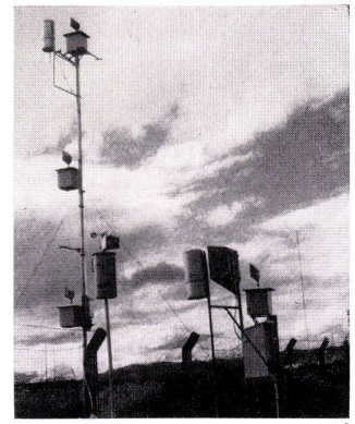
6 Meßgeräteanordnung zur Registrierung des Schlagregens.
