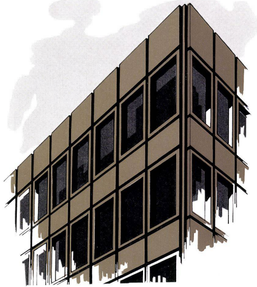
Neubau A. Messerli AG, CH-8152 Glattbrugg, beim Bahnhof. Fassadenbleche aus Peraluman-150, Colinal behandelt. Farner & Grunder, Architekten SIA, Zürich.
