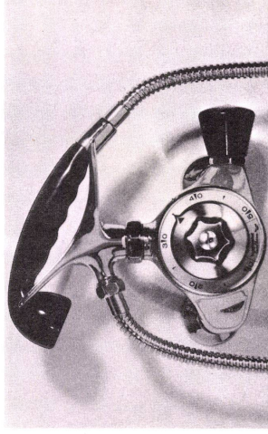
3971 DH Auflegegabel mit Rückstromsicherung und Handdusche Alle Mischventile für Wandmontage (für Dusche, Bidet, Waschtisch, Spültisch) mit freiem Auslauf. Abspernung des Kalt- und Warmwassers vor der Mischkammer durch eingebautes kombiniertes Absperrorgan.
