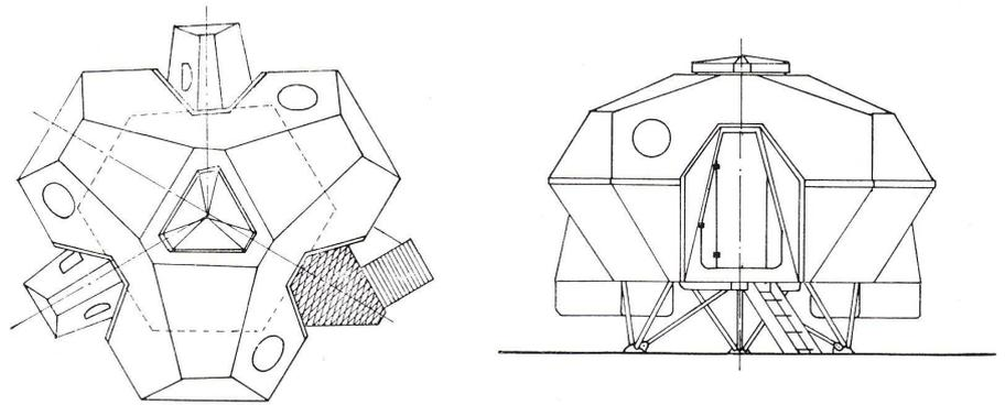
Die als Ferien- und Wochenendhaus-Unterkunft gedachte Raumzelle wird in vier Teilen angeliefert, die alle auf der Bodenplattform aufgebaut werden. Die Zelle besitzt zudem eine eigene Abfallbeseitigungsanlage. Bei größerem Raumbedarf können 2 oder 3 weitere Zellen dazugebaut werden.
