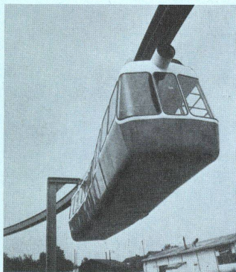
1 Versuchsanlage in Schmerikon am oberen Zürichsee. Geradlinige Streckenführung mit vorgespanntem Seiltragwerk, Stütze auf einem schwimmenden Ponton.
