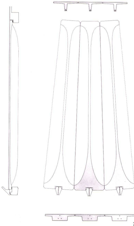
1 Vorgefertigte T-Betonträgerdecke über der Botschafts-Eingangshalle.
