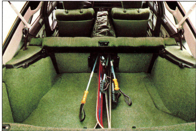
Durchladeeinrichtung mit Schutzhülle.
