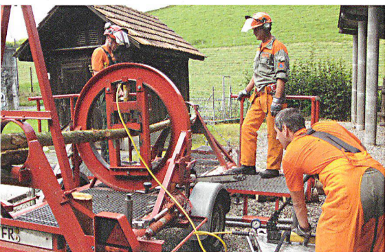
Mit dem Simulator kann man gefahrlos Holz zersägen, das unter Spannung steht.
