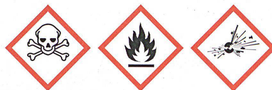
Neue, einheitliche Gefahrenpiktogramme für chemische Substanzen (von links): «Akute Toxizität», «Entzündbar», «Instabile explosive Stoffe».
